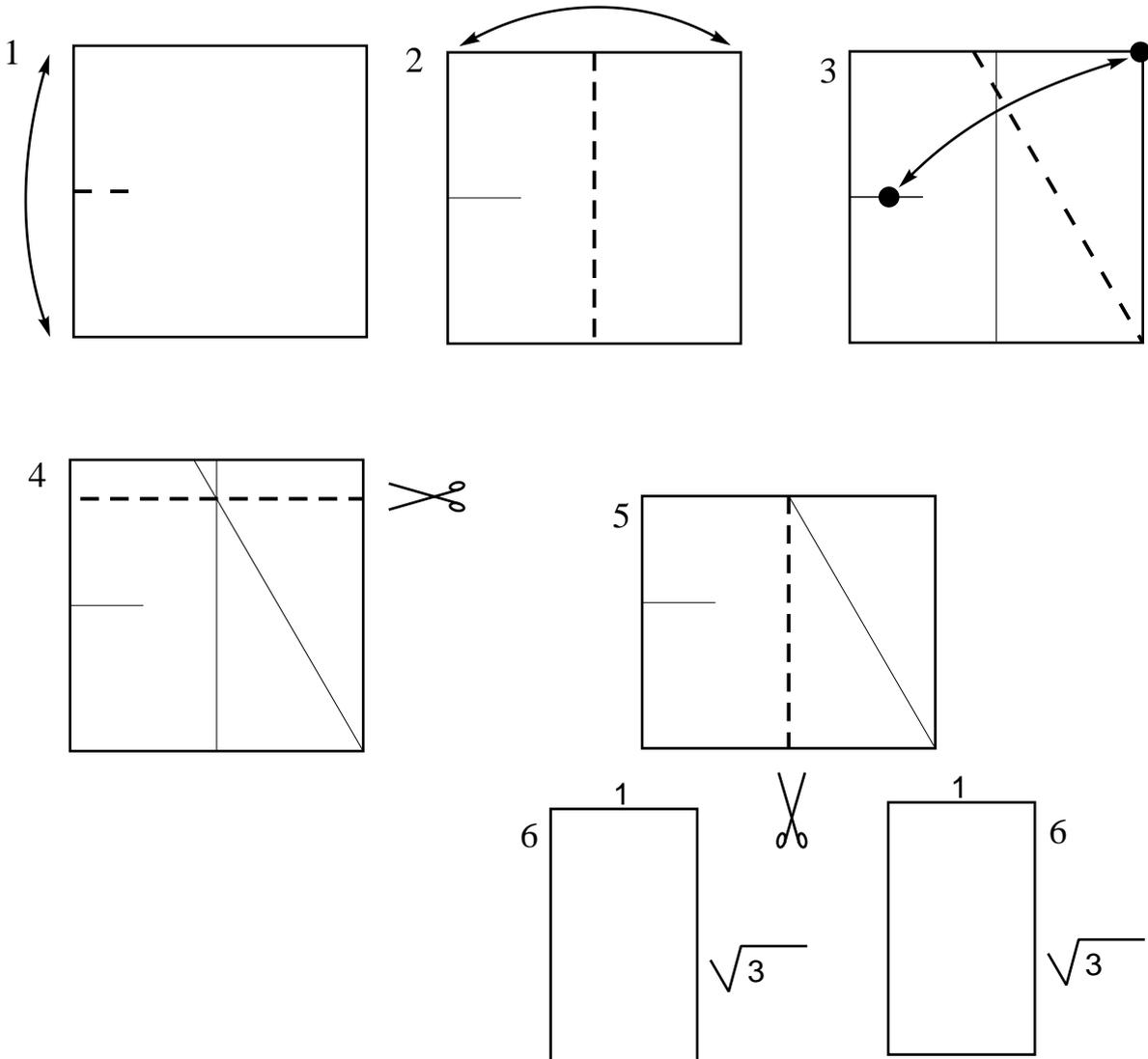
Questo rettangolo è la base di partenza per moltissimi modulari di Pietro Macchi. Basta portare uno spigolo inferiore sopra il suo opposto superiore per ottenere automaticamente un angolo di 60 gradi.
